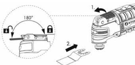
Nasadte nasazovací nástroj v požadovaném pracovním úhlu do uchycení pro nasazovací nástroj (10).
