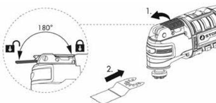
Placez l'embout dans le logement d'embout (10) en réglant l'angle souhaité.
