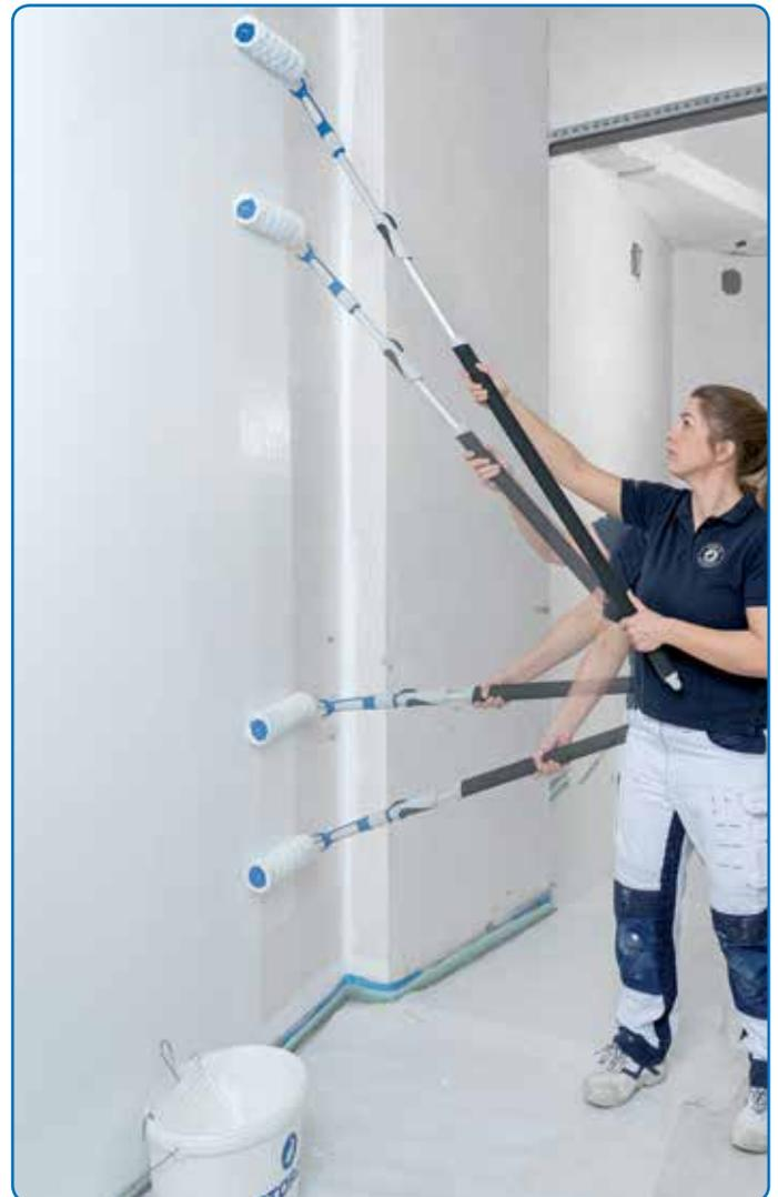
Der Doppelauszug erleichtert das Arbeiten auf engstem Raum enorm: Um den TeleSTAR von 130 auf 280 cm zu verlängern, muss das Arretier-Element lediglich um 80 cm bewegt werden. Und mittels Push-Lock Arretierknopf lässt sich Auszug blitzschnell lösen und wieder sicher fixieren.
