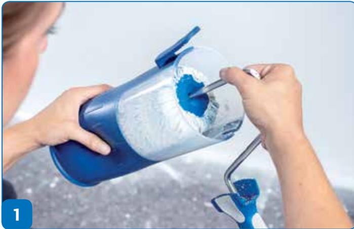
1 Walze von außen fassen, Bügel abziehen ...
