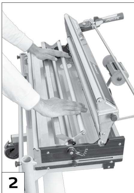
Inserzione dell'adattatore Aqua nel dispositivo di arresto. L'asta quadra è orientata verso il lato del tavolo del Tapetomat.
