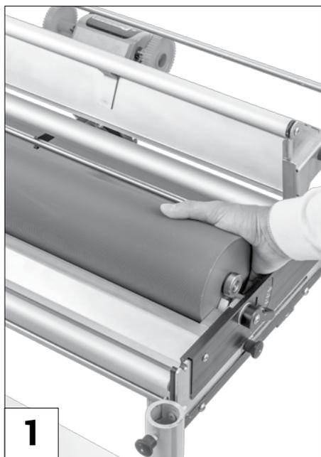
Prima del montaggio occorre rimuovere il distributore colla standard dal dispositivo Tapetomat.
