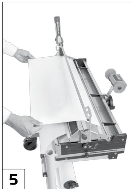
Den Deckel wieder verschließen und den benetzten Wandbelag bis zur Schnittkante vorziehen.
