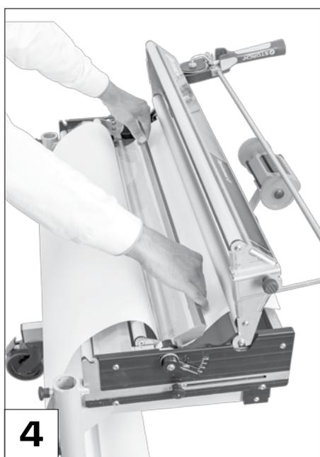
Girare l'adattatore in senso orario in modo che l'asta quadra sia rivolta verso il lato frontale del Tapetomat.
