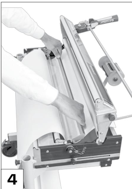
Drehen Sie den Adapter im Uhrzeigersinn, so dass die Vierkantstrebe zur Frontseite des Tapetomat steht.
