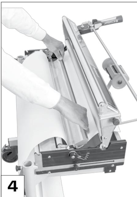
Tourner l'adaptateur dans le sens horaire de sorte que l'entretoise à section rectangulaire soit orientée vers le côté frontal du Tapetomat.
