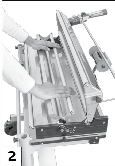
Mise en place de l'Aqua-Adapter dans le blocage. L'entretoise à section rectangulaire est orientée vers le côté table du Tapetomat.
