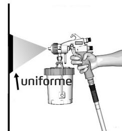
Flettere il polso per mantenere dritta la mira della pistola. Muovendo il ventaglio della pistola al fine di regolare l'angolo di spruzzatura si ottiene una finitura non uniforme.
