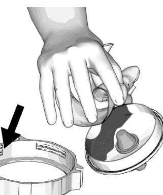
7. Naplňte vložka do nádobky (4) přibližně z poloviny čisticí kapalinou (teplá voda nebo vhodné rozpouštědlo).
