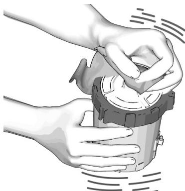
11. Vytřete a osušte všechny součásti systému nádobky. Odpovídajícím způsobem zlikvidujte čisticí kapalinu.
