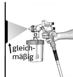
Armgelenk beugen, um Pistole gerade zu halten. Fächeln mit Pistole zum Verändern des Spritzwinkels bewirkt ungleichmäßiges Auftragen.
