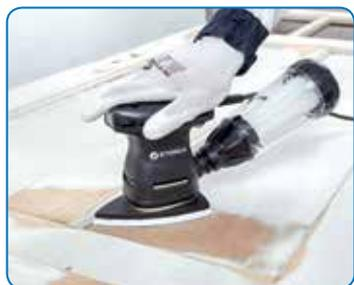
Pour le ponçage ponctuel moyen et grossier jusque dans les endroits difficilement accessibles, et pour le ponçage moyen de petites surfaces.
