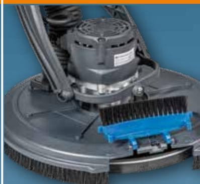
Motore senza spazzole con elettronica a velocità costante per un lavoro uniforme.
