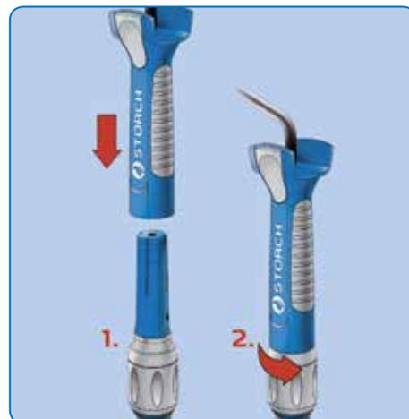
Enficher la monture sur la barre de rallonge télescopique, blocage du système LOCK-IT par une simple rotation de la bague de blocage.
